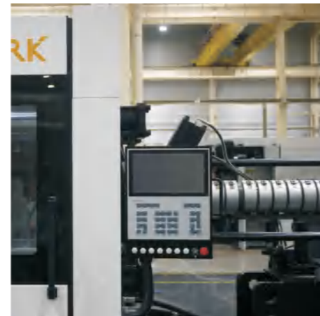
倍福控制系统 BECKHOFF CONTROL SYSTEM
